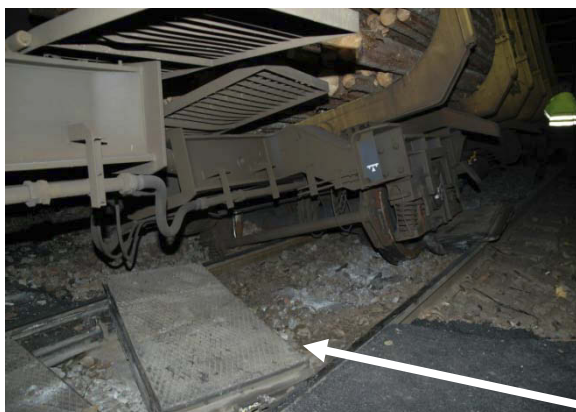
Figur 3: Viser skadde straillelementer.
