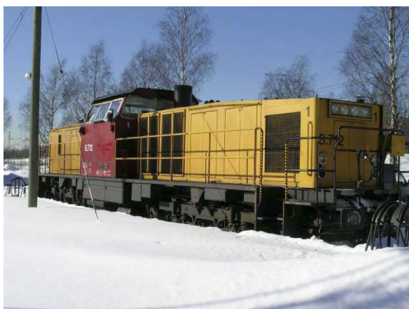
Figur 12: Viser et D18-lokomotiv, og eksosanlegget som dekker noe av sikten fra førerrommet ved kjøring fra ende 1.
