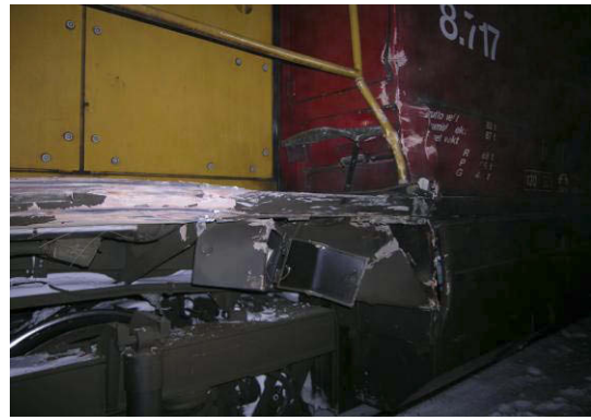
Figur 5: Skadene på det fremre lokomotivet i godstoget.
