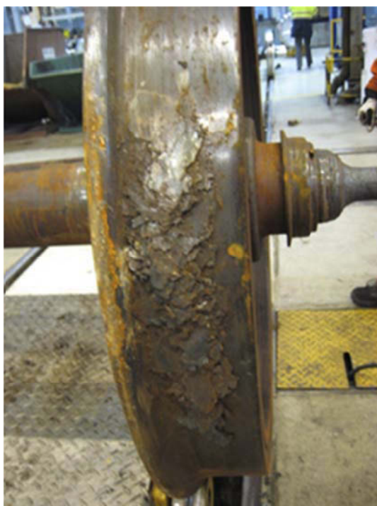
Figur 5: Tydelig opprulling på hjulene. Foto: CargoNet AS.
