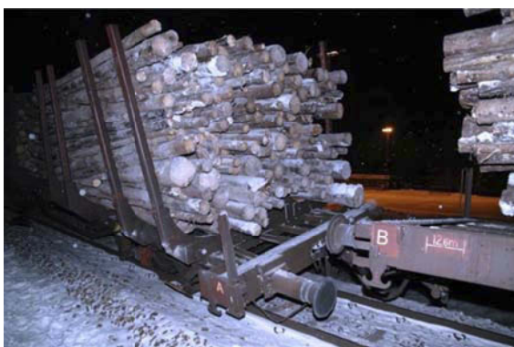
Figur 3: Lasten krenget sterkt mot venstre. Her sett fra togets venstre side.
