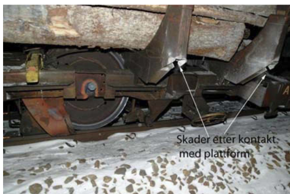
Figur 1: Venstre side av skadet aksel. Akselkasse, fjær og bakre akselkasseføring mangler.
