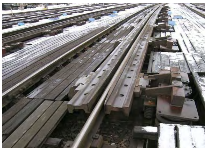
Figur 8: Fastholdebremsen er en bjelkebrems som klemmer mot vognhjulene.
