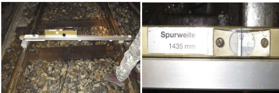
Figur 5 og 6: Måling av sporvidden på ulykkesstedet viste stor sporutvidelse.
