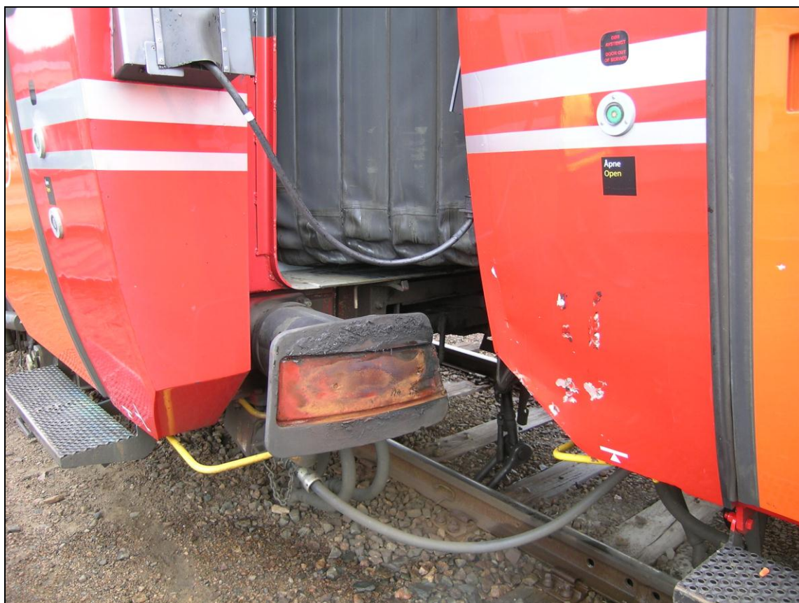
Figur 12: Viser at ombufring har skjedd mellom vogn 1 og 2. Glideplaten på buffer mangler. (Vogn 1 til høyre).
