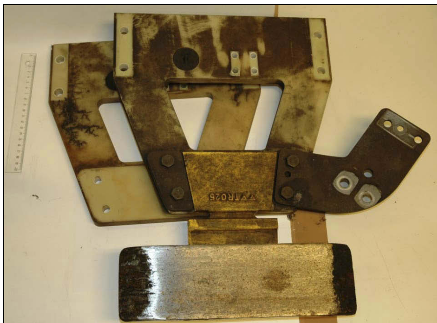
Figur 6: Oversiktsbilde av de to undersøkte isolatorplatene/strømavtakerne. Slesko vises i nederste bildekant.
