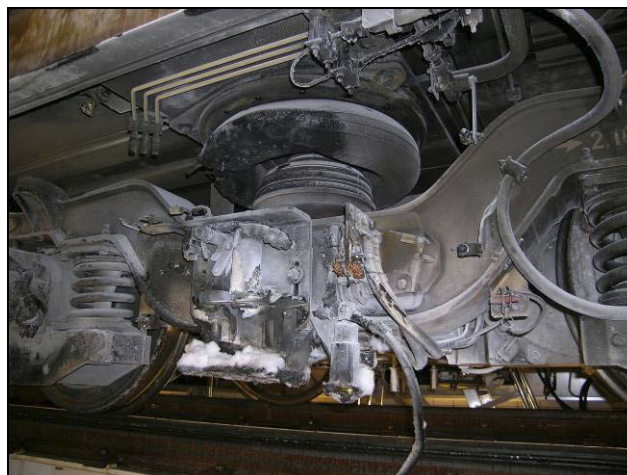
Figur 4: Viser skader som oppstod på strømavtager som brant ved Holmen stasjon, januar 2010
