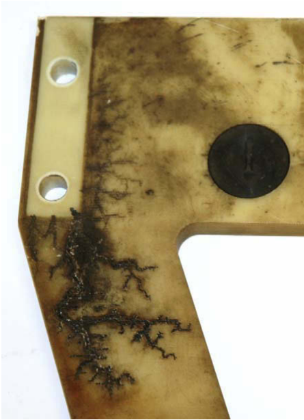
Figur 7: Utsnitt av varmpåvirkede områder på isolatorplate
