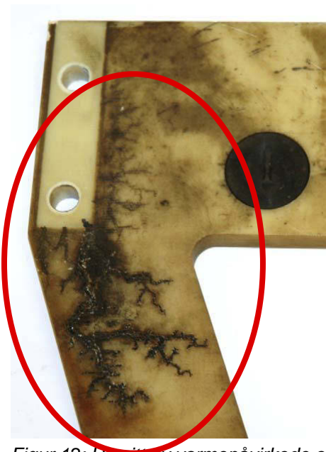
Figur 12: Utsnitt av varmpåvirkede områder på isolatorplate
