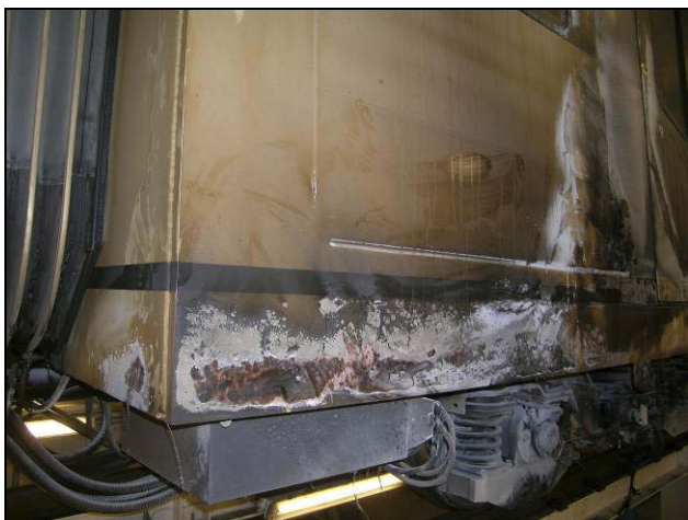
Figur 5: Viser utvendige skader på vognen som brant ved Holmen stasjon, januar 2010.
