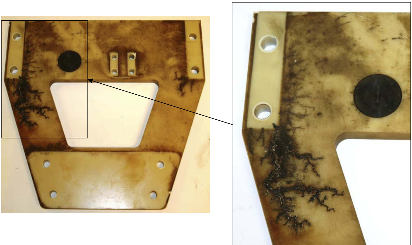
Figur 2 Bilde av isolasjonsmaterialet med spor av mulig overslag.
