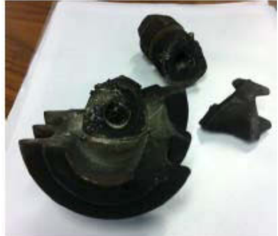
Figur 17: Viser en defekt opphengsisolator.
