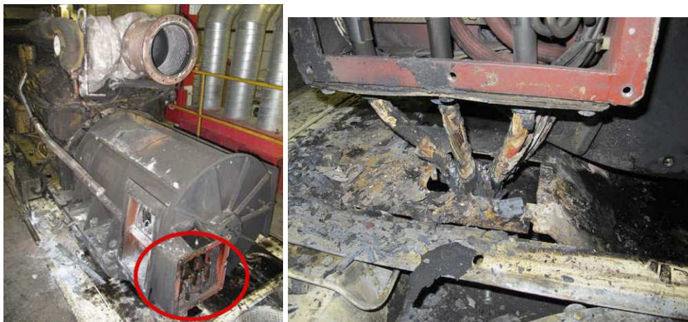
Figur 8: Hull for kabelgjennomføring.
