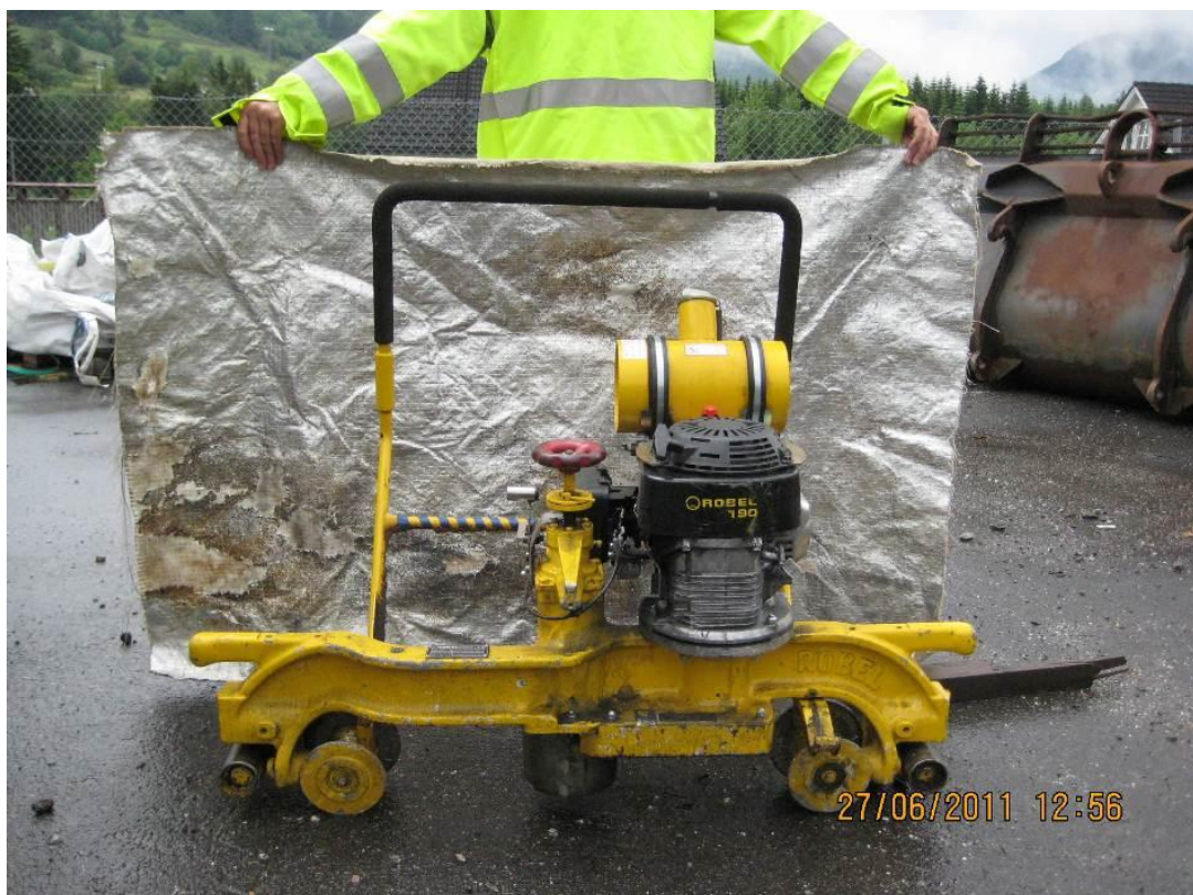
Figur 6: Slipemaskin og sveiseduk som ble brukt (kilde: NJD)
