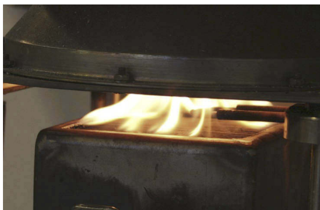
Figur 4-5 Planke, forsøk ved 50 \text{ kW/m}^2 , 24 s etter antennelse.
