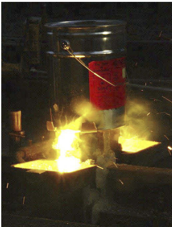
Figur 5-7 Flytende varmt materiale fra termitt-sveis.
