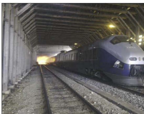
Figur 12: Kl. 11:37 Bilde fra vestre snøoverbygg. Brannen ses i bakgrunnen, og man kan se at kobbel på bakerste togsett er klargjort. Det er strøm på lavspenningsettet ettersom det er lys i snøoverbygget. (Kilde: Voss brannvesen)
