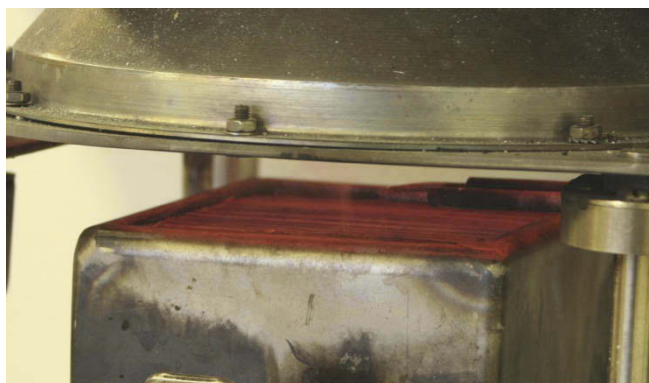
Figur 4-3 Planke, forsøk ved 50 \text{ kW/m}^2 , <12 s etter start, rett før antennelse.
