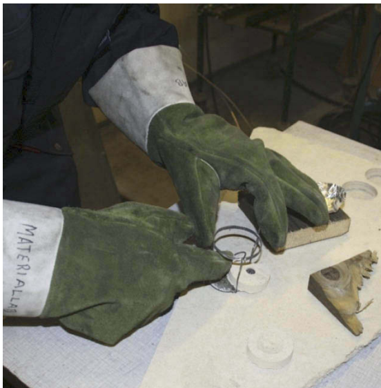
Figur 6-3 Håndtering av oppvarmet materiale.
