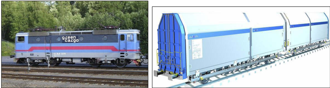
Figur 4: Bilde av svensk lokomotiv type Rc4 og skisse av bilvogn type Laaeilprs.
