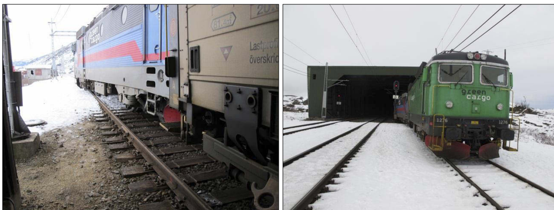
Figur 2: Bildene viser det avsporede lokomotivet og første vogn i toget, samt toget forfra.
