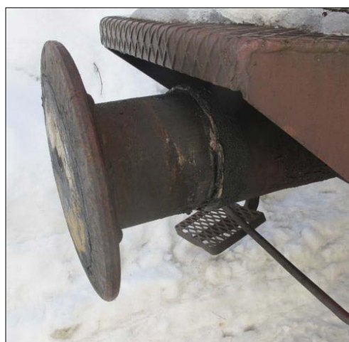
Figur 10: Buffer på 335 vogn (kilde: SHT).
