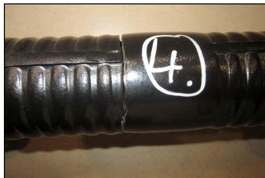
Figur 17: Brudd i tuben ved dynamisk test 4 [10].
