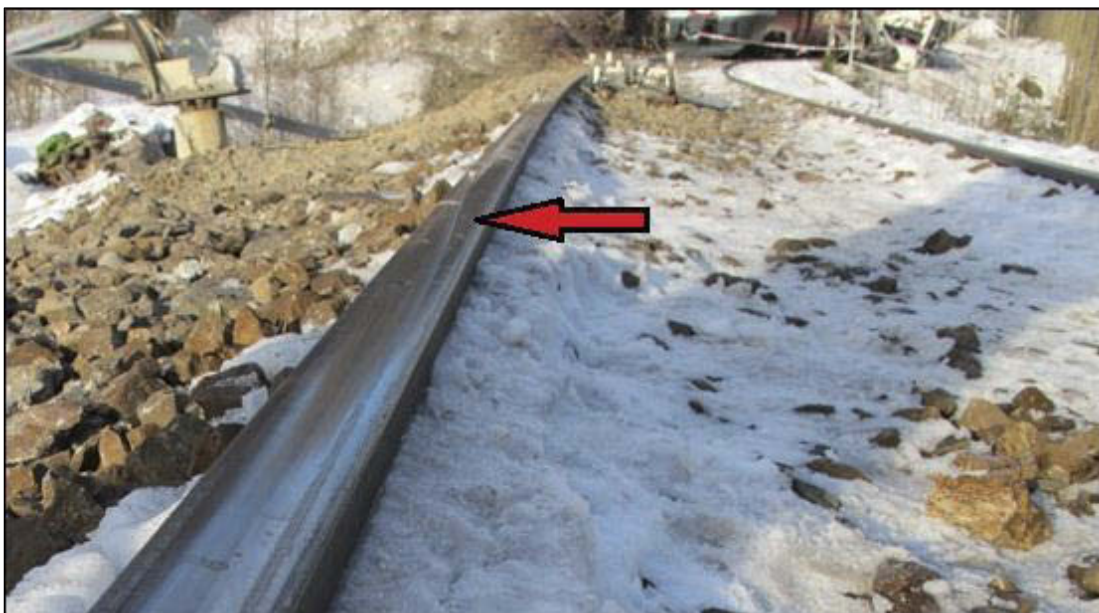
Figur 12: Avsporingsmerke kun på venstre skinnestreng (foto: SHT).
