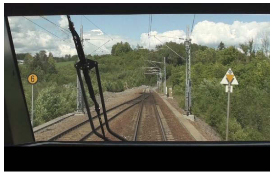
Figur 19: Markeringsmerke for hastighetsnedsettelse (foto: SHT).
