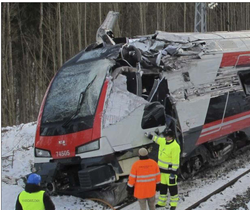
Figur 26: Fronten med synlige forsterkninger (foto: SHT).
