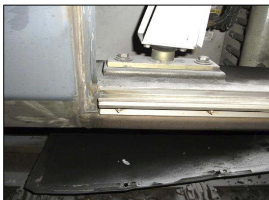
Figur 4: Viser litt av skadene i underredet etter eksplosjonen (Kilde: SHT)
