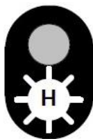
Figur 10: Signal 56 «Planovergangen kan passeres» / Signal 58 «Planovergangssignalet viser at planovergangen kan passeres»
