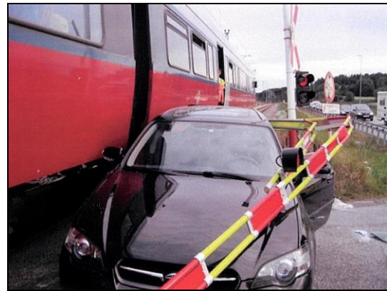
Figur 3: Skader på kjøretøyet og bom. Foto: Politiet
