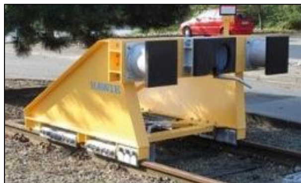
Figur 10: Energiabsorberende endebutt med friksjonselementer. Endebutten var ikke involvert i ulykken. Foto: Rawie.de
