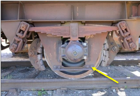
Figur 26: Markert understykke (fra vognas bakre, venstre hjul). Foto: SHT
