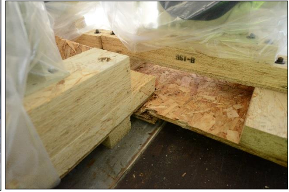
Figur 22: Last kan ha forflyttet seg i rykket som oppstod. Foto: SHT
