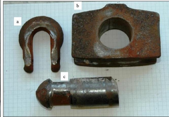
Figur 18: Klave uten låsesplint, mellomstykke og bolt med bruddskade. Foto: FOLAT
