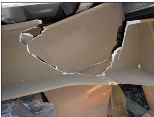
Figur 10: Skader der akselkasseføring er festet til vognrammen (langbjelken). Foto: SHT
