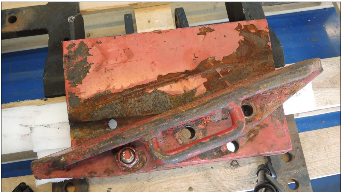
Figur 10: Oppkjørt sporsperre i normal posisjon. Foto: SHT
