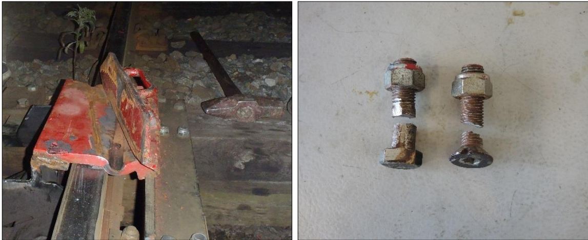
Figur 8: Oppkjørt sporsperre. Avsporingsvinkel flyttet tilbake til normal posisjon. Foto: SHT
