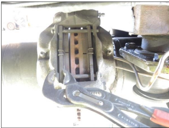
Figur 8: Uvirksom brems høyre foran. Foto: SHT
