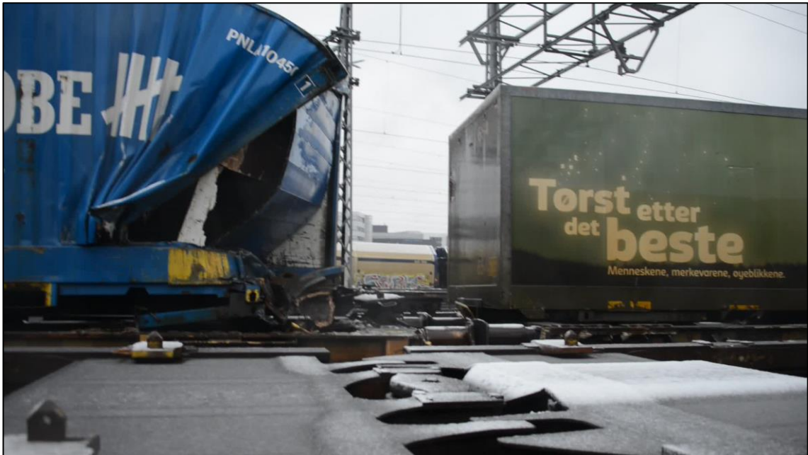
Figur 5: Skader på containere i godstoget på vogn 5 (grønn) og 6 (blå). Foto: SHT
