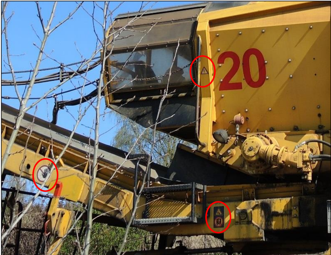
Figur 3: Materiell med skilting av farer ved stigtrinn. Foto: SHT
