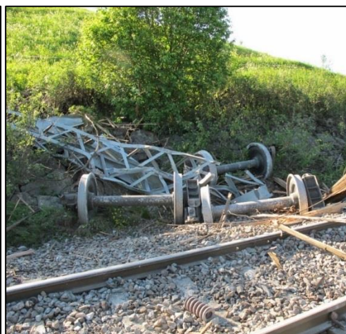
Figur 5: Hjul løsnet fra vogn. Foto: SHT
