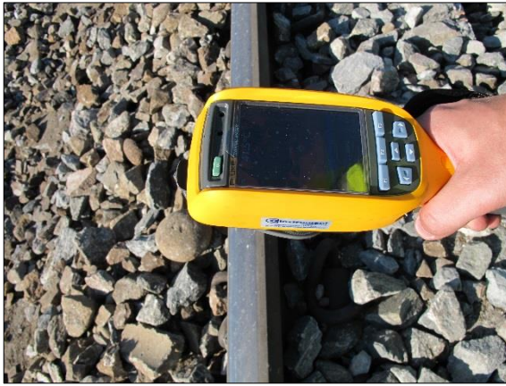
Figur 21: Fluke termokamera for måling av skinnetemperatur. Foto: SHT
