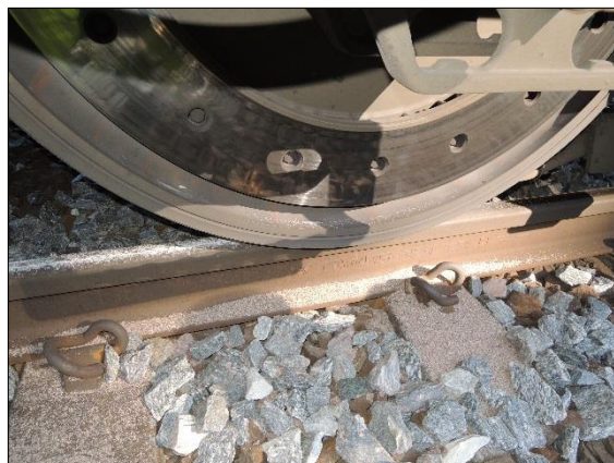
Figur 11: Spor fra sanding for hjul på lokomotiv ifm. nødbrøms. Foto: Bane NOR
