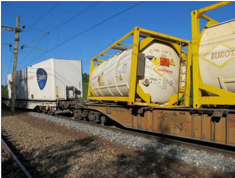
Figur 13: Beholder har forskjøvet seg. Foto: SHT
