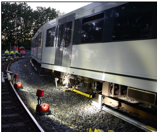
Figur 2: Avsporet boggi lørdag 3. september 2016. Foto: SHT
