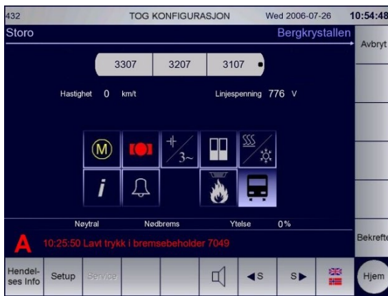
Figur 18: 3-vognstog slik det angis i førers HMI-system. Kilde: Sporveien T-banen
