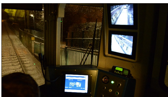
Figur 12: Plassering av monitor i et MX3000 førerrom. Foto: SHT
