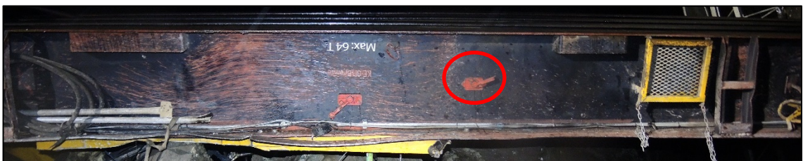
Figur 10: Håndtak (rød ring) i steng stilling og synlig skrapemerker på pukksugereren. Foto: SHT
