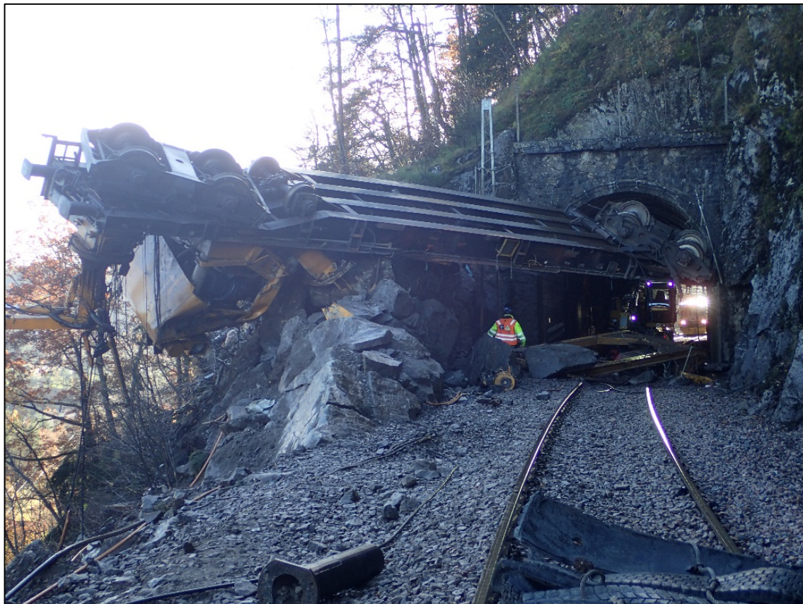
Figur 3: Pukksugeren etter avsporingen. Foto: SHT
