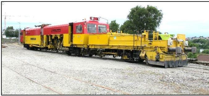
Figur 11: Pakkmaskin. Foto: SHT
