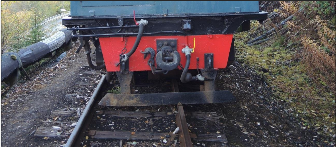
Figur 5: Skadet avspøringsvern. Foto: SHT
