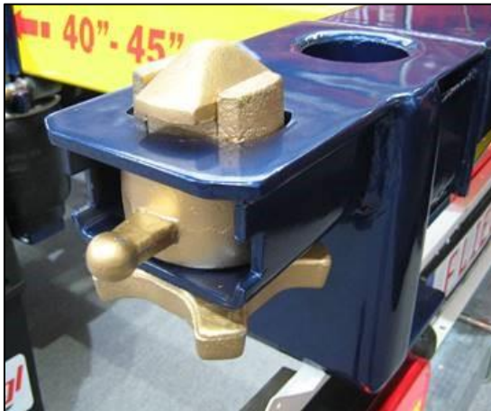
Figur 20: Twistlock-systemet. Foto: Statens jernbanetilsyn
