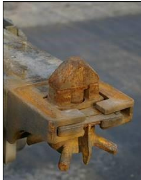
Figur 21: Twistlock-systemet. Foto: Statens jernbanetilsyn
