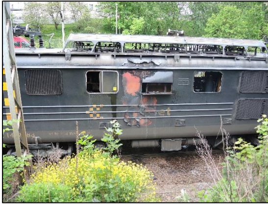
Figur 3: Trykkavlastingslukene blei blåsne opp. Brannvesenet knuste vindauga. Foto: SHT
