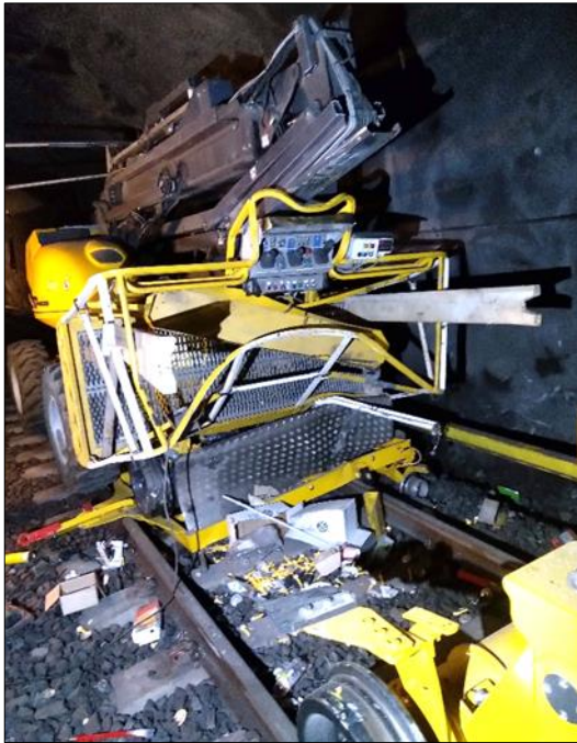
Figur 1: Teleskopliften etter sammenstøtet. Foto: BMO Entreprenør AS
