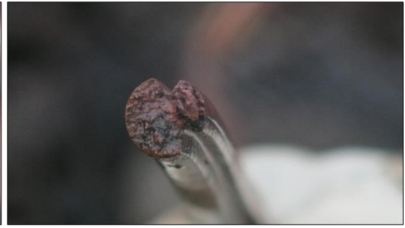
Figur 32: Mekanisk brudd på KL (våt tilstand). Foto: SHT
