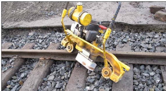
Figur 39: Eksempel på slipemaskin med gnistfanger. Foto: SHT
