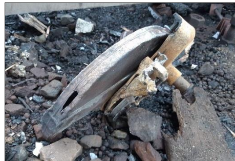
Figur 40: Gnistfanger på utstyr til skinneskapping. Foto: Vitne
