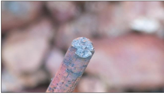
Figur 31: Mekanisk brudd på KL. Foto: SHT
