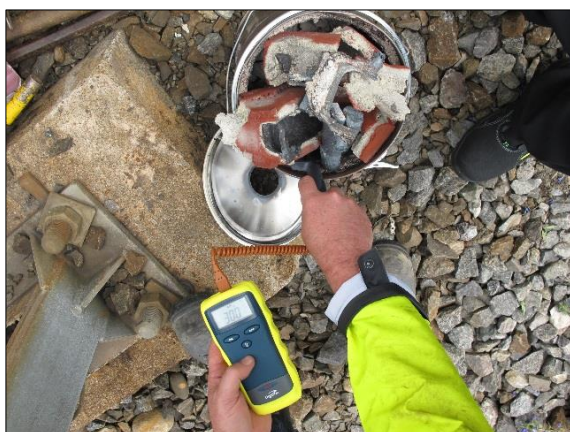
Kl. 1411: Thermit-restene holder fortsatt 300 °C. Foto: Gnister sprutet 1,5 meter. Foto: SHT
