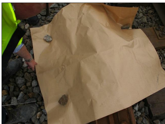
Perler fra sliping antente ikke papir. Foto: SHT
