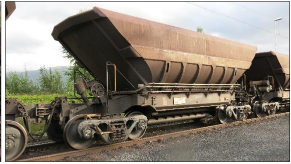
Figur 19: Malmvogn F050 Fammoorr (to sammenkoblede F040 Fanoo). Foto: SHT
