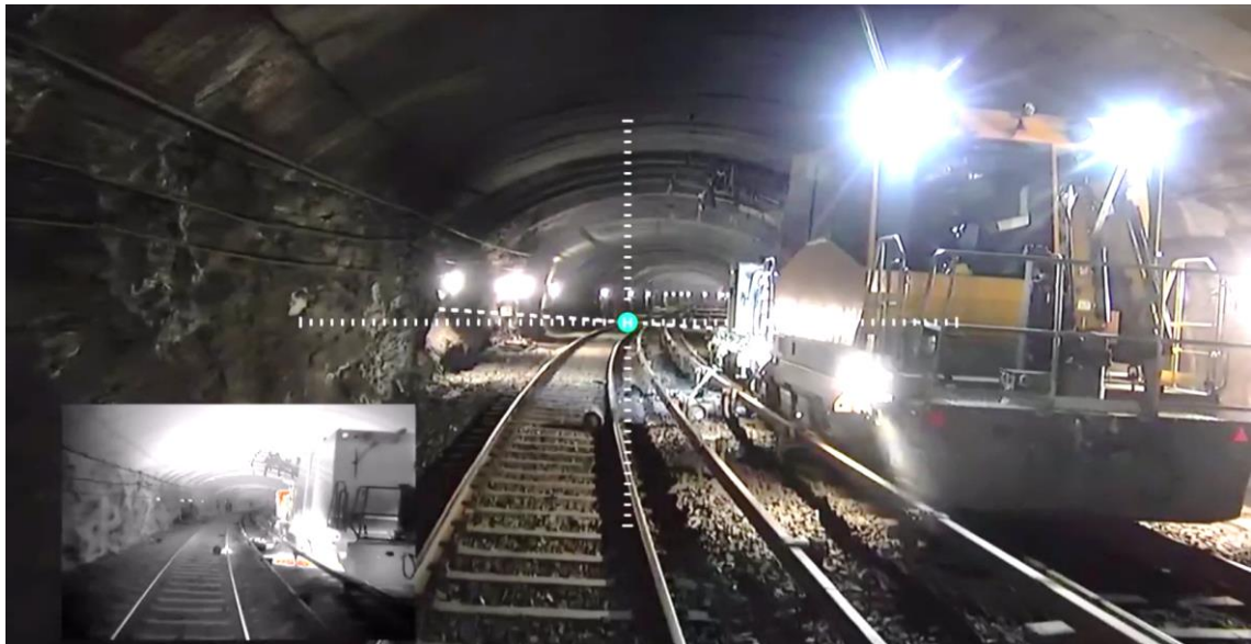
Figur 10: Trekkjøretoy (Robel) som er tilkoblet sveisevognen. I nedre venstre hjørne ser man bilde fra IR-kamera som viser temperaturutslag i farger. Dronefoto: Brannvesenet (NRBR)
