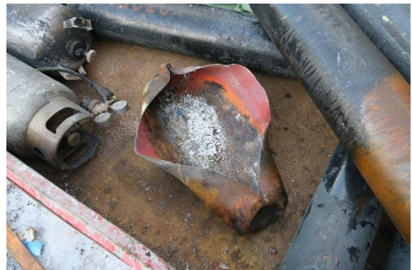
Figur 14: Acetylenflasken som revnet under brannen. Foto: SHT
