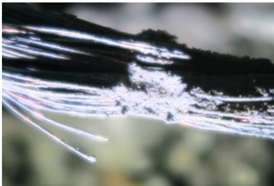
Figur 13: Kortslutningsspor på batterikabelen. Foto: SHT
