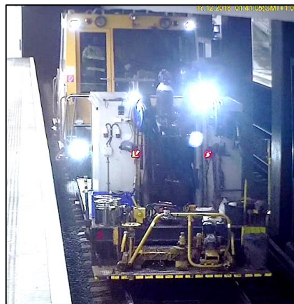
Figur 7: Bilde fra overvåkingskamera på Helsefyrt som viser sveisetilhengeren bak på arbeidstoget på vei til oppdraget før brannen. Foto: Sporveien AS
