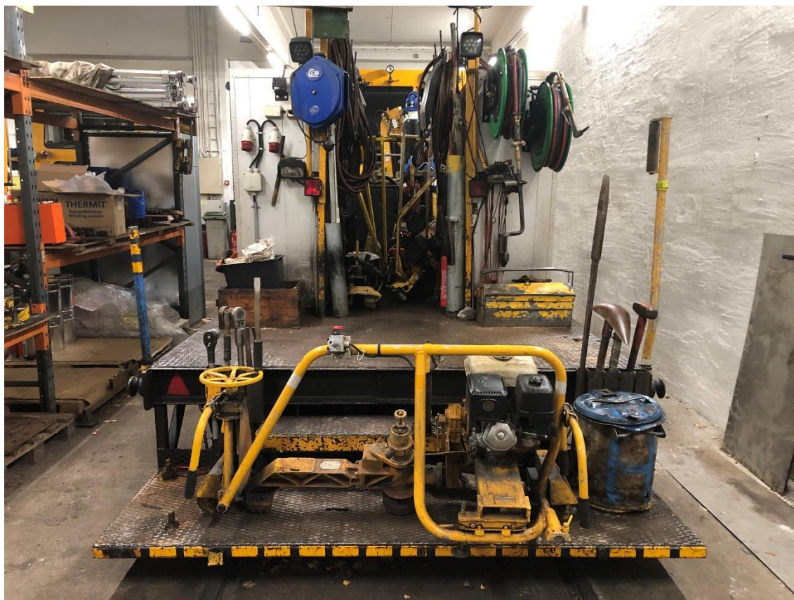
Figur 8: Bilde av sveisevognen fra bakre ende hvor slipemaskinen er plassert. Foto: Sporveien AS
