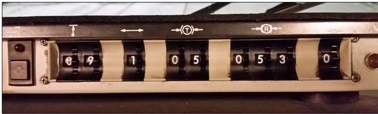
Figur 34: Innstillinger på ATC-panel i førerrom som ble benyttet ved hendelsen. Foto: CargoNet AS
