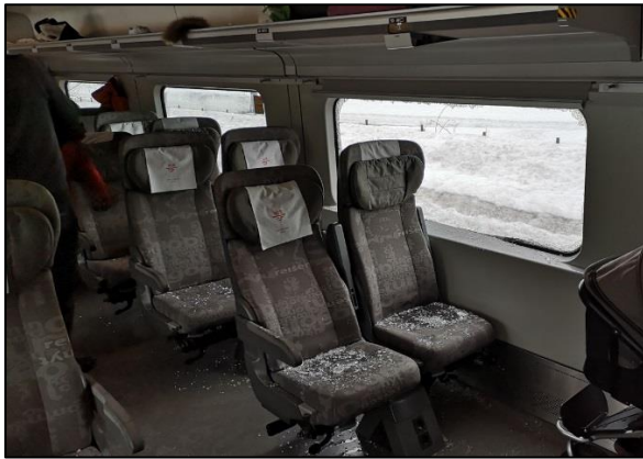
Figur 2: Glasskår etter knust vindu tog 62 den 26. mars 2019. Foto: Helge Sunde
