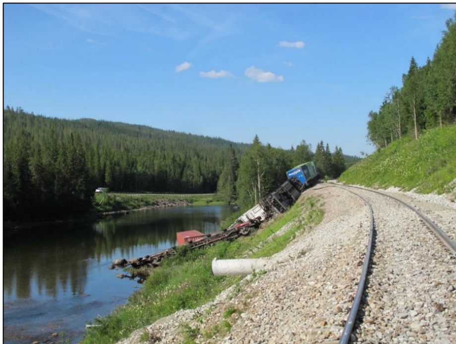
Figur 3: De bakerste avsporede vognene i toget. Foto: SHT
