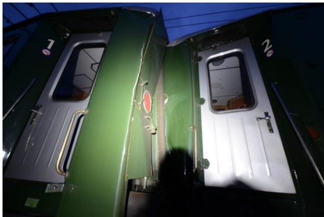
Figur 8: Vogn 1 og 2 i tog 1859 ble presset sammen. Foto: SHT
