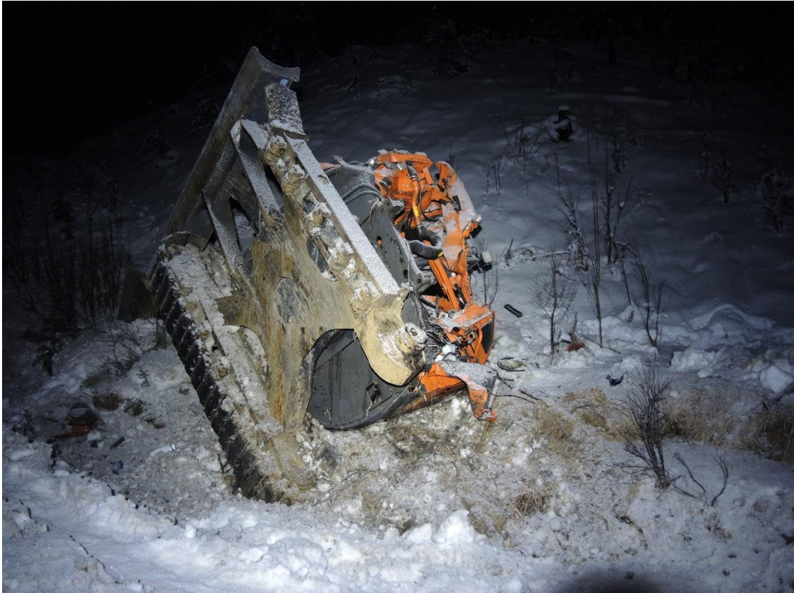
Figur 3: Gravemaskinen til høyre for sporet etter sammenstøtet. Foto: SHK
