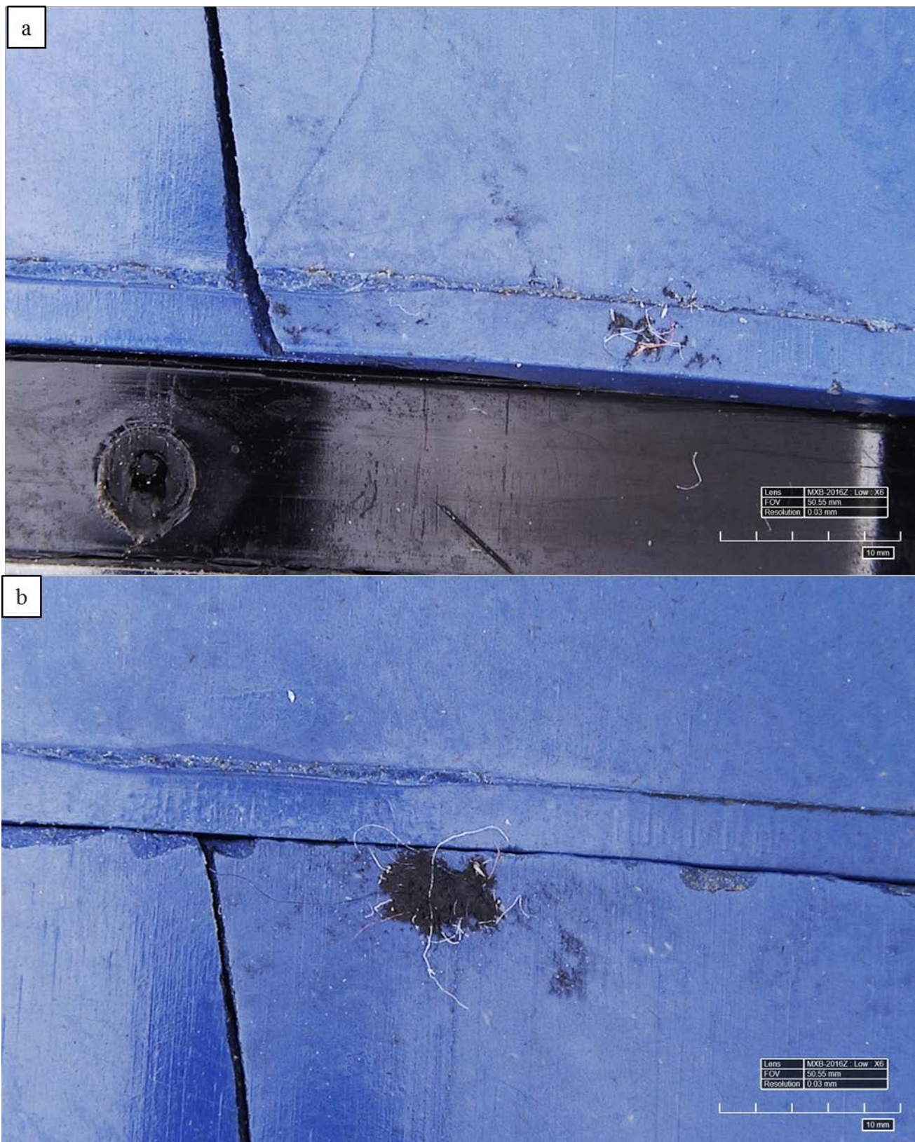
Figur 5ab: Bilde i digitalmikroskop av plastbit satt tilbake på kontakt for sammenligning av overflatebeskaffenhet og farge.
