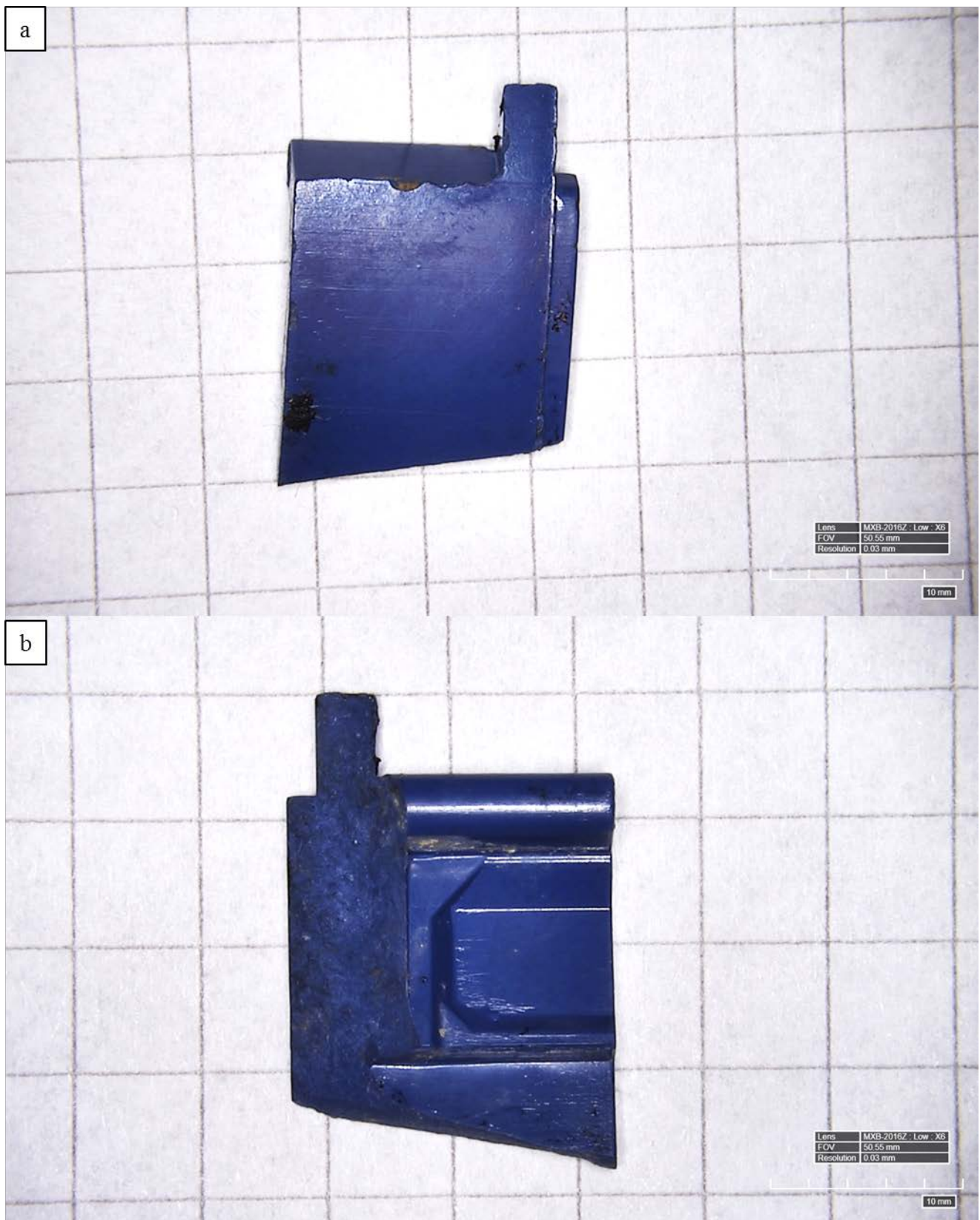
Figur 4 Bilde i digitalmikroskop av plastbit fra kontakt a: fremside og b: bakside.
