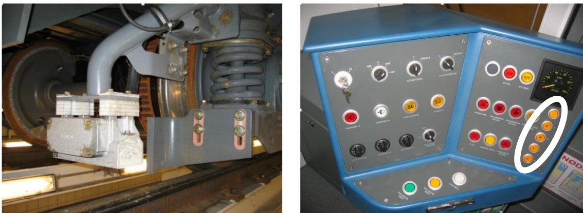
Figur 6: Antennene plukker opp koden fra sporet og viser den på displayet til fører som bokstavkode (markert med hvit ring). Foto: Sporveien T-banen AS
