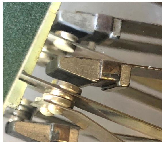
Figur 23: Ingen andre kontakter har tilsvarende spor som kontakt 1. Foto: SHK
