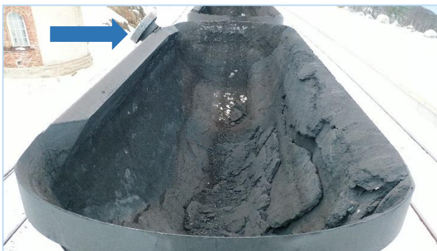
Figur 16: Lastrester i avsporet vogn 87 74 6845027-6. Fotoet er tatt motsatt av togets kjøreretning. Pilen peker på hjulet som benyttes ved tømming av vogn. Foto: SHK
