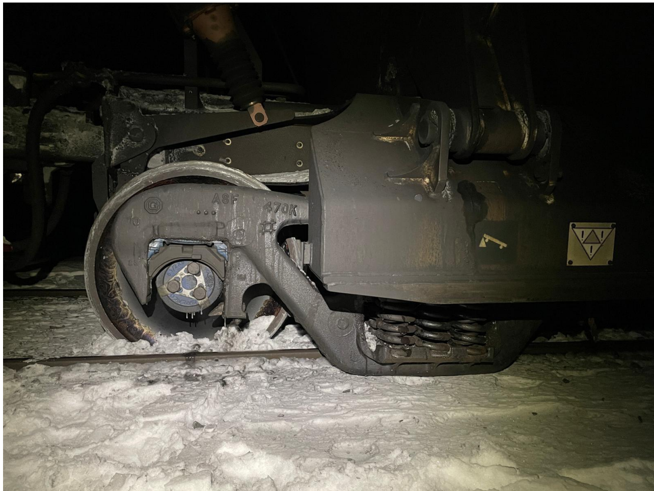
Figur 1: Avsporet boggi slik den ble funnet av føreren. Foto: Railcare T AB
