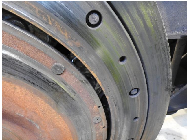
Figur 24: Havarert gummielement på SAB-hjul. Foto: SHK
