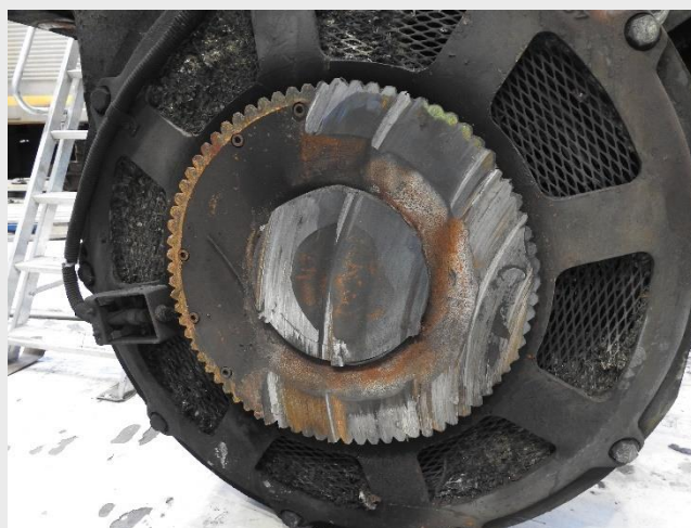
Figur 12: Tannhjul for hastighetsgiver. Foto: SHK
