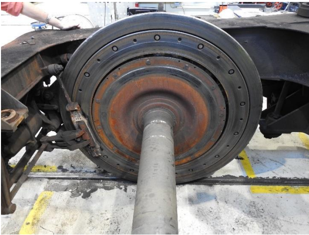
Figur 23: Varmepåvirket hjul og boggiramme. Foto: SHK
