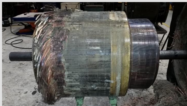
Figur 9: Rotor med skadete viklinger. Foto: CargoNet AS
