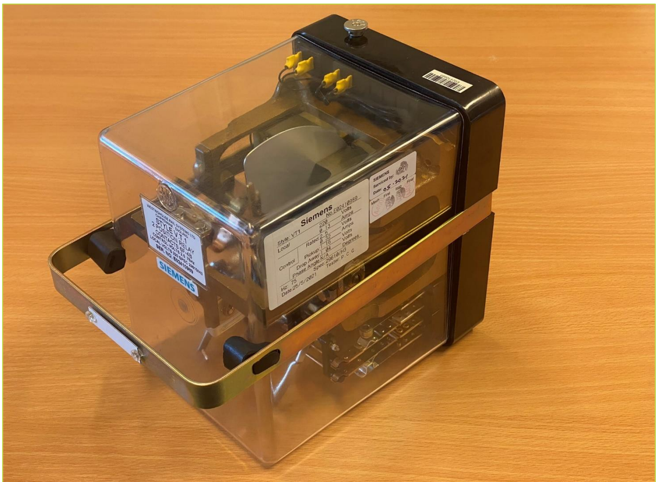
Figur 2: Relé av type V.T.1-6F-4B. Foto: SHK
