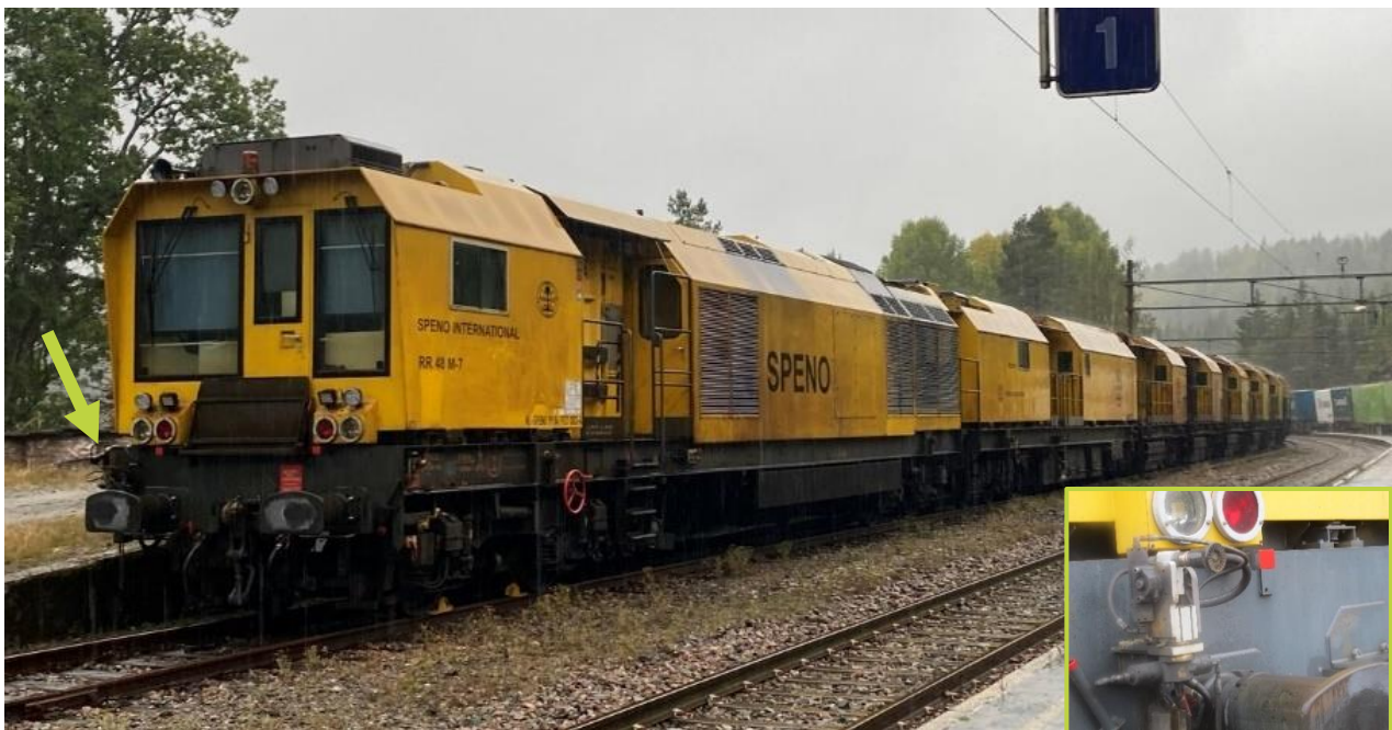
Figur 6: Slipetog RR 48 M-7 på Nelaug stasjon. Vasskanonen er markert og vist på det innfelte bildet. Foto: SHK
