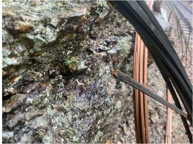
Figur 18: Enden på kontaktledningen. Foto: SHK
