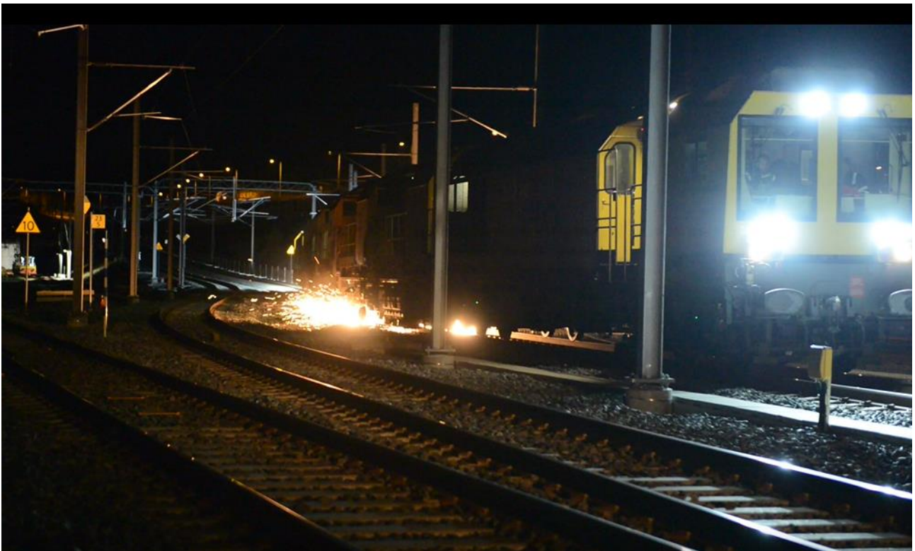
Figur 10: Skinneslipetoget i arbeid på Ski stasjon. Foto: SHK
