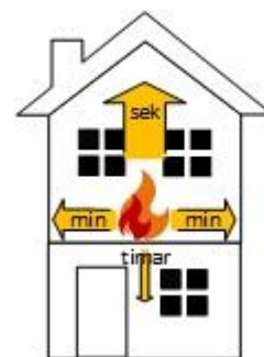
Figur 38: Brannspreiing. Illustrasjon: SHK
