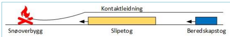
Figur 37: Brannberedskapstogget kom seg ikkje fram til brannen. Illustrasjon: SHK
