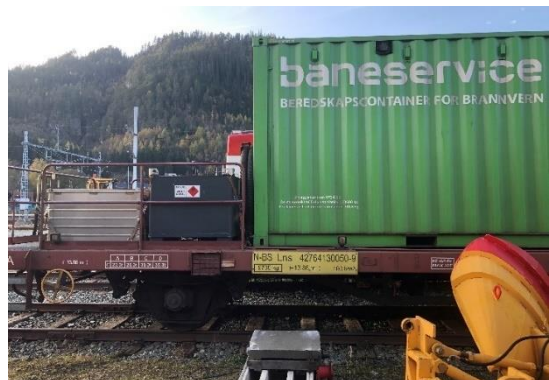
Figur 9: Lns med brannberedskapskonteinar. Foto: Grenland Rail AS
