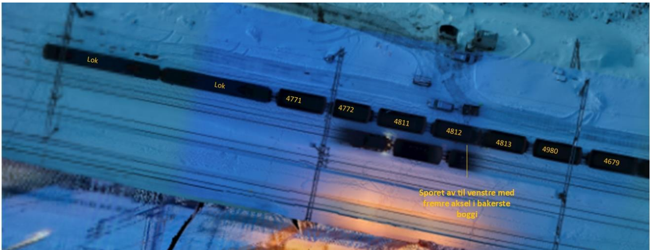
Figur 7: Fremre del av avsporet tog. Foto: Tiepoint AS
