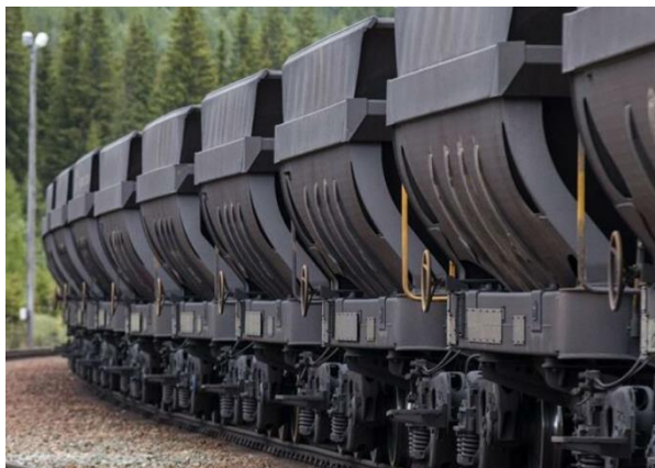
Figur 6: Malmvogn med bunntømming konstruert av Kiruna Wagon AB. Foto: Kiruna Wagon AB
