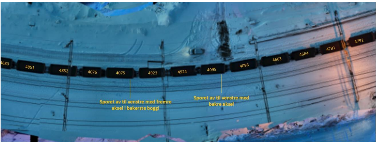
Figur 8: Midterste del av avsporet tog. Foto: Tiepoint AS
