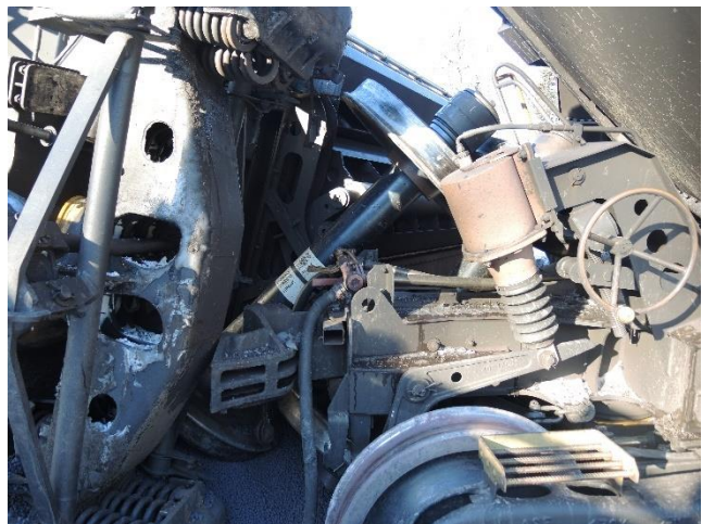
Figur 14: Løsnet aksel. Foto: SHK
