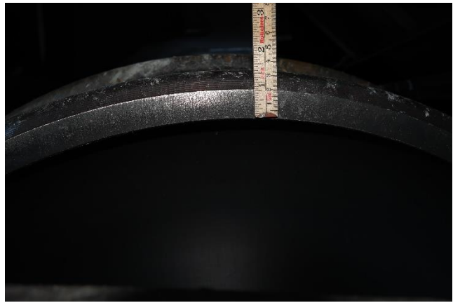
Figur 12: Slitasje på hjul på første aksling på bakre boggi på vogn 4. Foto: SHK
