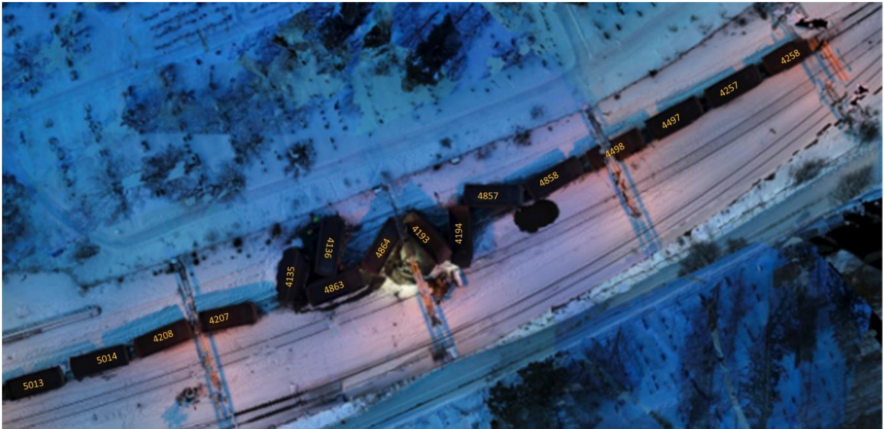
Figur 9: Bakre del av avsporet tog. Foto: Tiepoint AS
