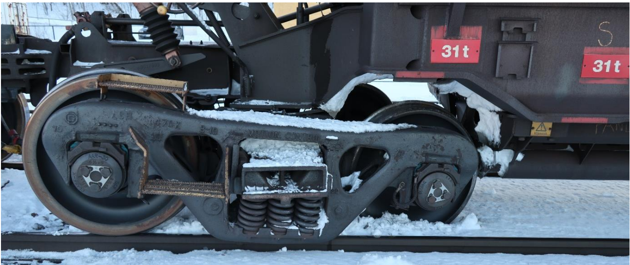
Figur 10: Avsporet aksling vogn 4. Foto: SHK
