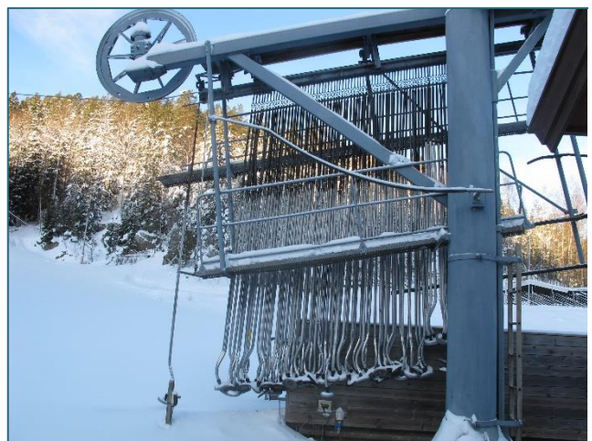
Figur 11: Teleskopmedbringere med skål. Foto: SHK
