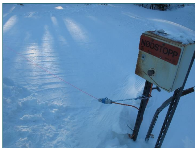
Figur 5: Stoppsnor. Snoren er koblet opp etter ulykken. Foto: SHK
