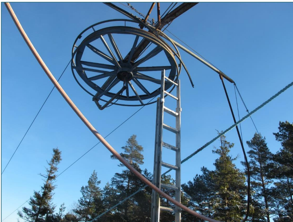
Figur 2: Skiheisens vendehjul på toppstasjonen med stige for å komme til smørepunkt. Foto: SHK
