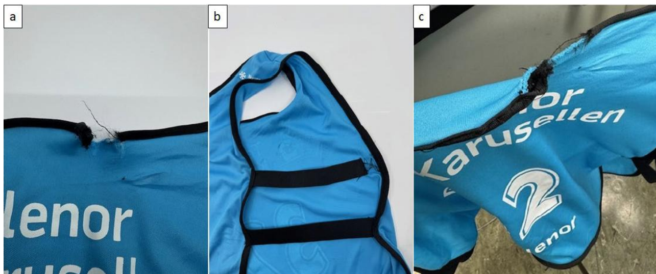
Figur 16: Bilete av startnummervesten etter testing av a) halsopninga, b) strikken i sida og c) halsopninga med defekt kanteband. Foto: FOLAT
