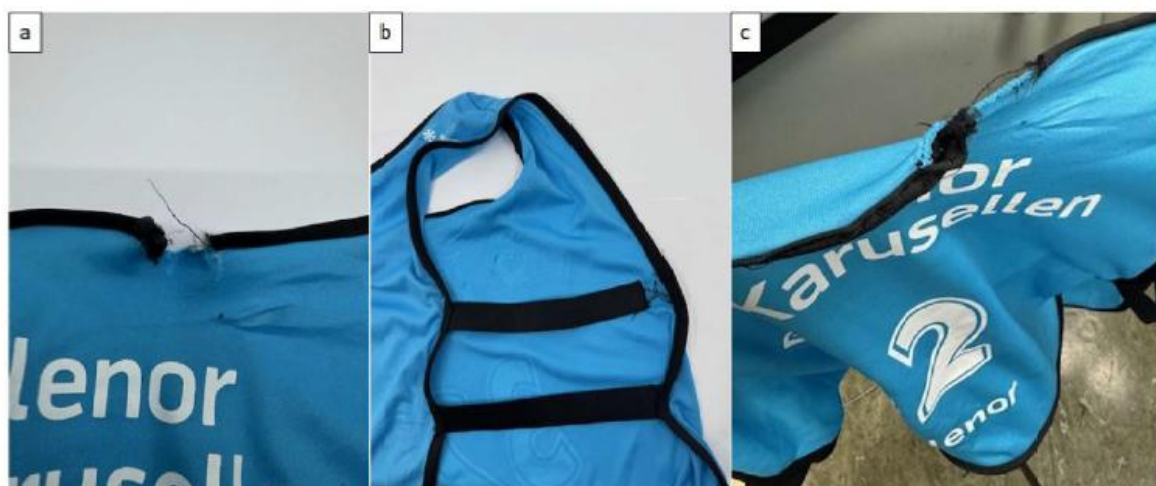
Figur 3 Bilde av startnummervest etter testing a) halsåpning, b) strikk i siden og c) halsåpning med defekt kantbånd.
