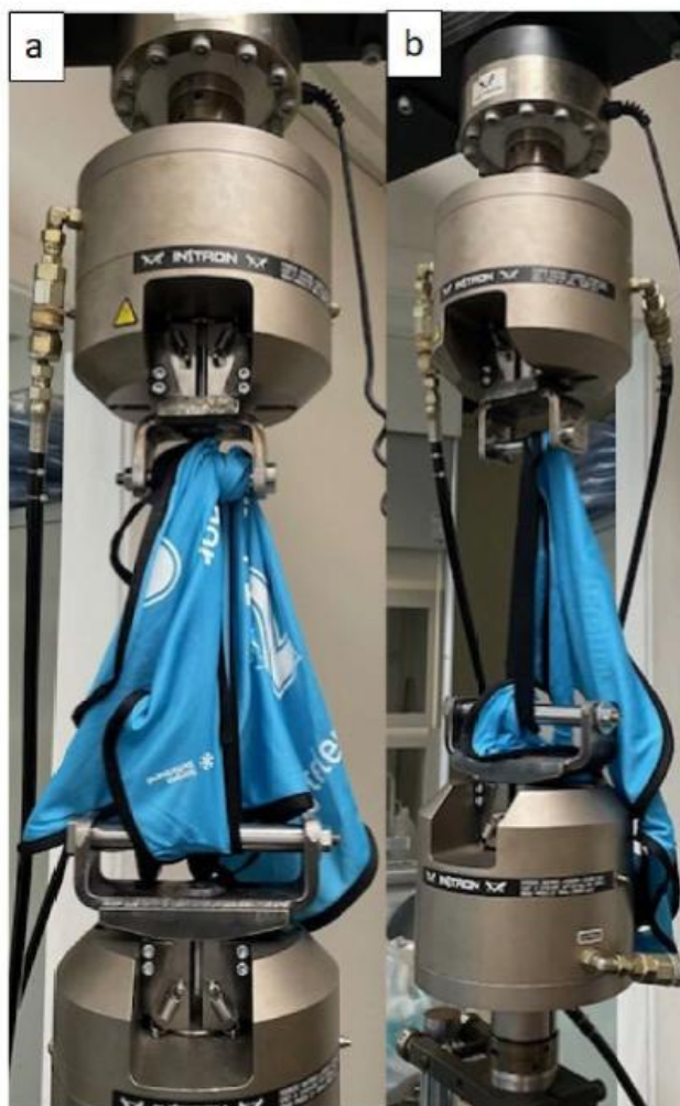
Figur 2 Bilde av innfesting av startnummer i Instron 8516 strekkmaskin, a) testing av halsåpning og b) testing av strikk i siden.
