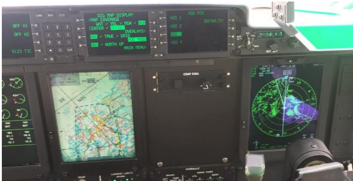
Figur 15: HDD 3 og 4 på høyre side i Cockpit. HDD 3 viser digitalt kart mens HDD 4 viser Monopulse Ground Map (MGM). Kilde: Luftforsvaret
