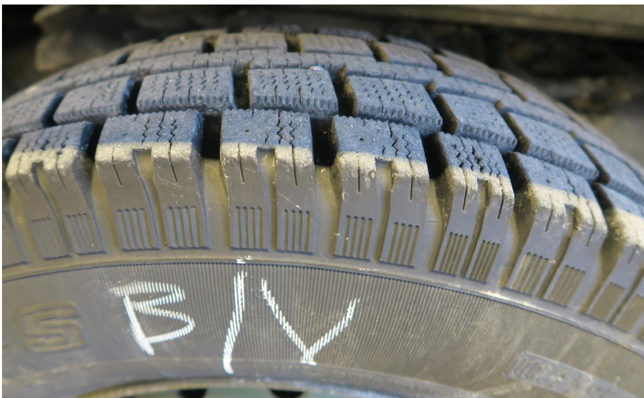
Figur 12: Mønster på feltvognens bakre venstre dekk. Foto: SHK
