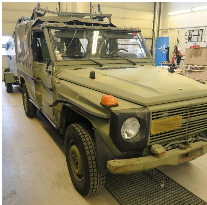
Figur 5: Skader på feltvognens høyre side. Foto: SHK.
